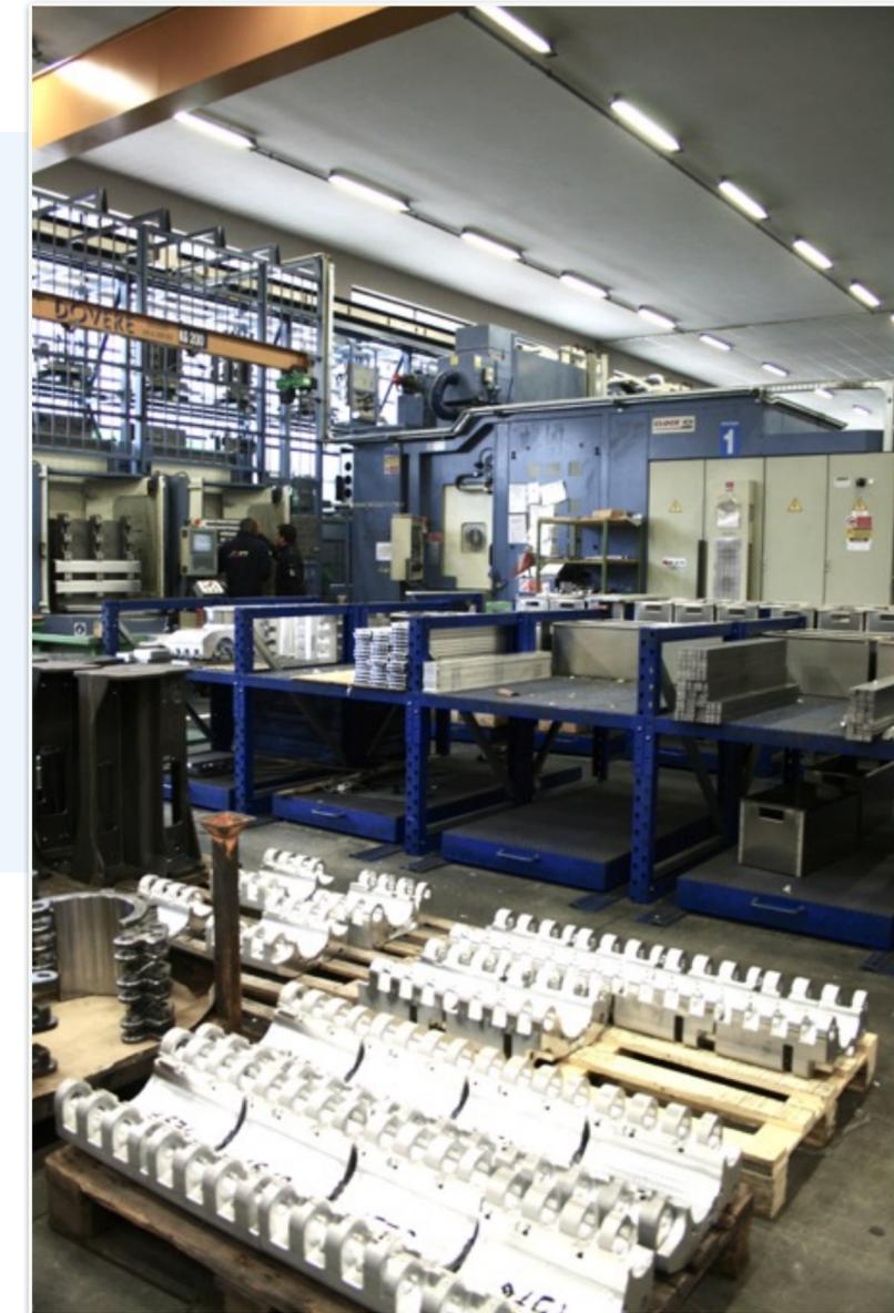
Centro di lavoro CNC in linea FMS costituito da 4 macchine della serie “Clock 1200”;
