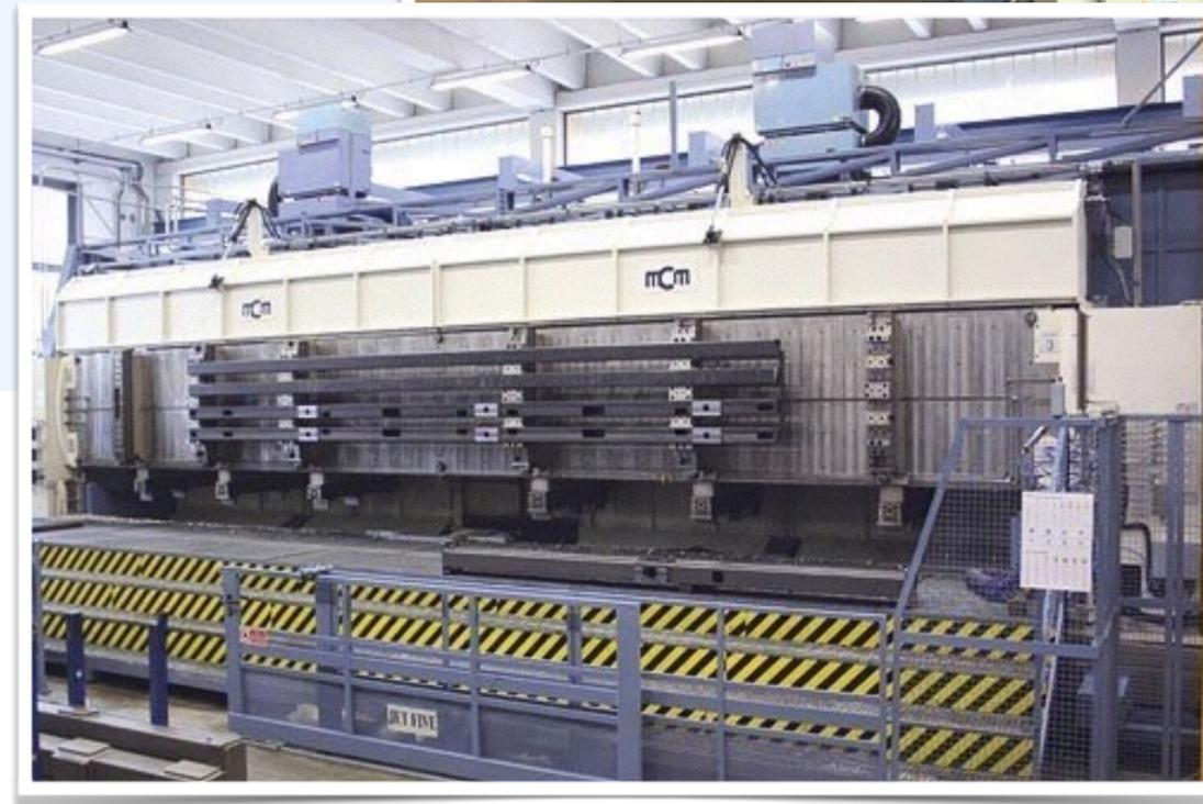
L'insediamento industriale SMIMEC è dotato di 20 centri di lavoro CNC di cui 15 collegati in linea FMS, che sono in grado di eseguire programmi di produzione prestabiliti anche in assenza di operatori.
